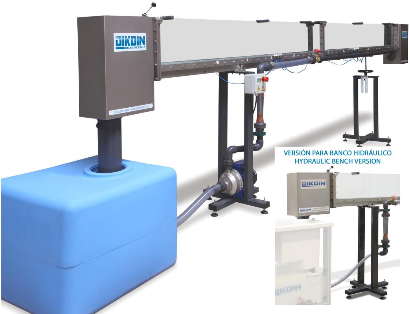
Este equipo está diseñado para estudiar el comportamiento de los fluidos en canales abiertos, mediante la realización de una amplia gama de prácticas y experiencias.
