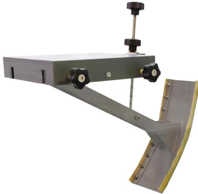
Accesorio Opcional: HD.Z.12 - COMPUERTA RADIAL (Para canal hidrodinámico)
